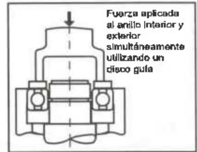
Montaje Contra Eje y Alojamiento Simultáneamente
